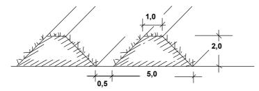
Höhe: max. 2,00 m Länge: unbegrenzt Breite: max. 5,00 m Querschnitt: trapezförmig
